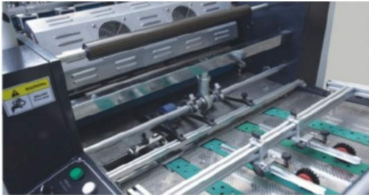
Taquets de contrôle chevauchement et repérage latéral pour plus de précision sur les chevauchements courts
