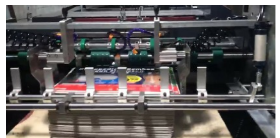
Stacker pneumatique , direct palette
