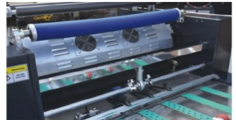
Chauffage de la calandre par électromagnétique de dernière génération. Rapidité en montée de température, et utilisation d'une grande calandre chromé DUR
